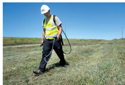
Échantillonnage de la qualité de l'air à la surface des cellules
