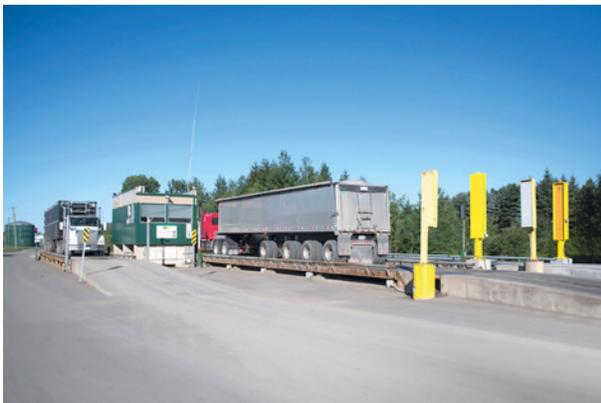
Enregistrement et contrôle des chargements au poste de pesée
